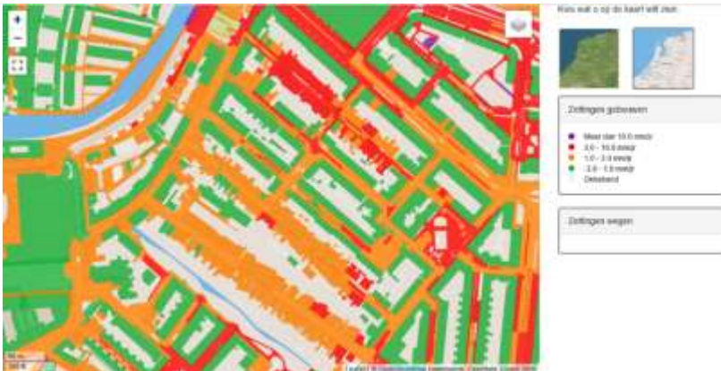
Zettingsgegevens van woningen en straten uit de Klimaatatlas van de Gemeente Schiedam
