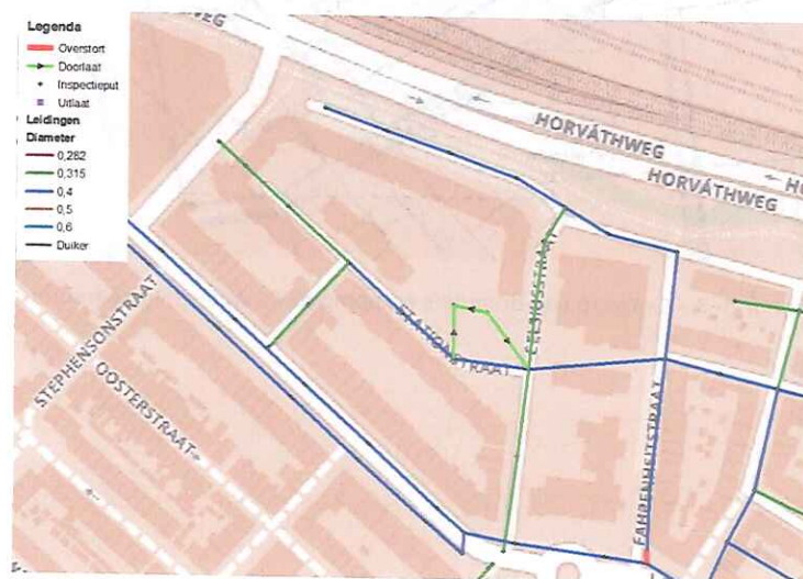
Figuur 3-2 – Rioolontwerp met in kleur de diameter van de leidingen en met berging geschematiseerd als knopen en doorlaten
